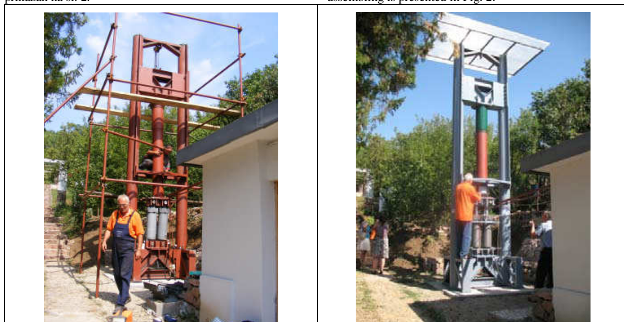
Slika 2. Hidraulična kidalica sa zatvorenom petljom: aksijalna promenljiva sila do \pm 5000 kN i pomeranje do \pm 265 mm, sa vertikalnim okvirom za gabarite do 5000x3000x1000 mm, postavljena na otvorenom
