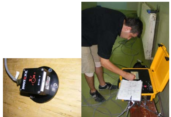
Акцелометар типа Дигитеџ велике осетљивости и тачности \pm 0.1\% . и систем за аквизицију и конверзију сигнала.
